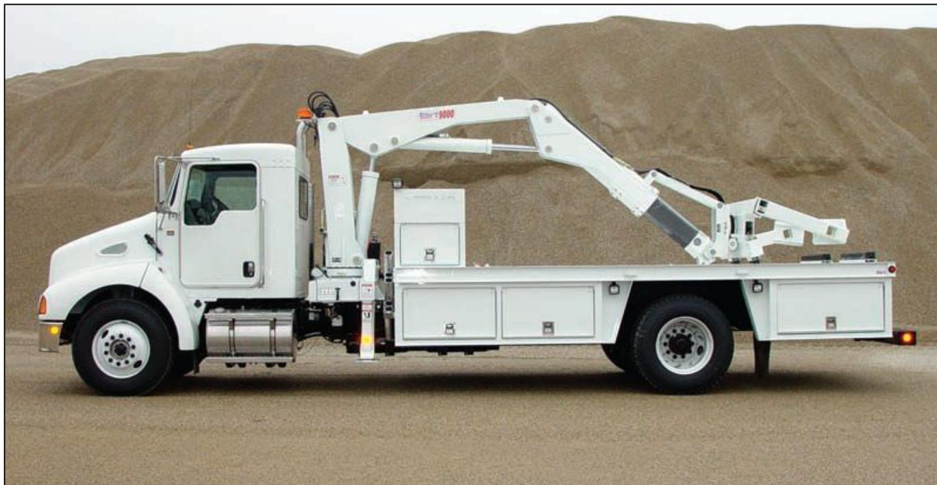
Мобильный сервисный комплекс Stellar TM4110 разработан для выполнения ремонтных работ и замены КГШ размером от 18.00R25 до 24.00R49 в условиях карьера.
